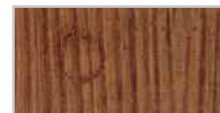
Hagelschlag nach einem Jahr Bewitterung Mit Pflegebalsam: Intakte Oberfläche
